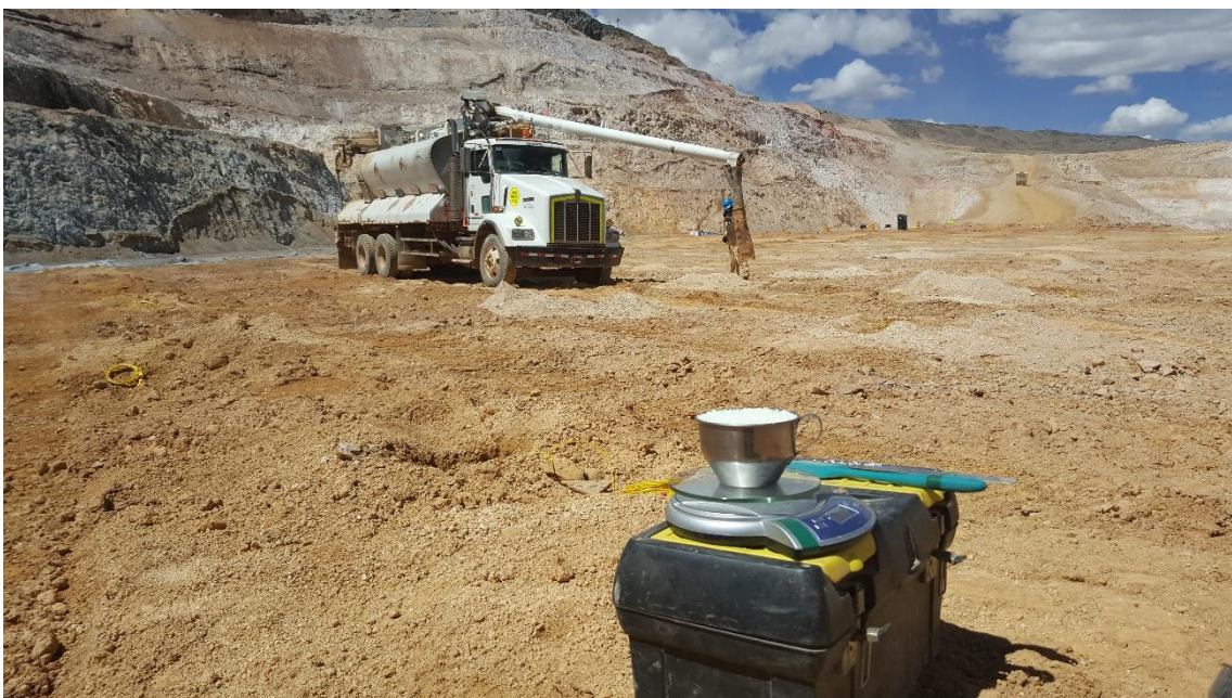
Foto 21. Control de densidades de los explosivos. Fuente: Autor del informe de trabajo profesional.
