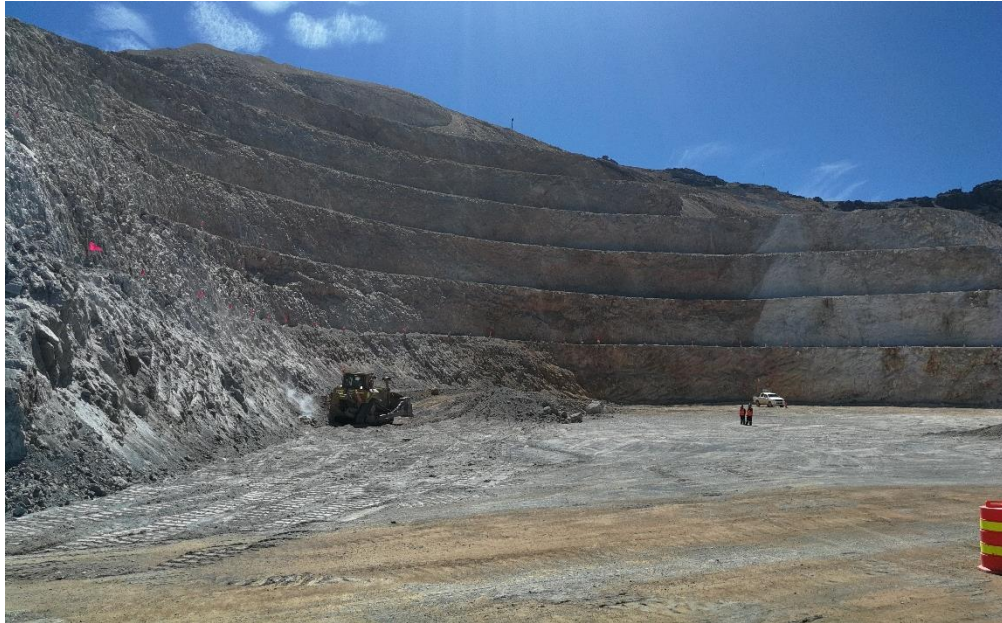
Foto 14. Foto de limpieza de plataforma de perforación. Fuente: Autor del informe de trabajo profesional.
