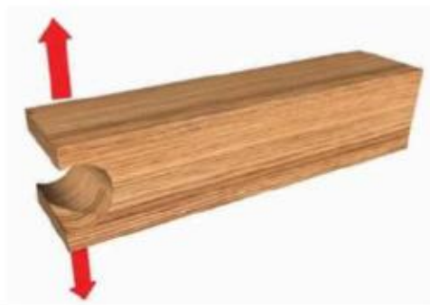
FIGURA 46. Esquema de clivaje radial:
