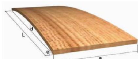
FIGURA 52. Alabeo o deformación de la madera llamada arqueadura:
