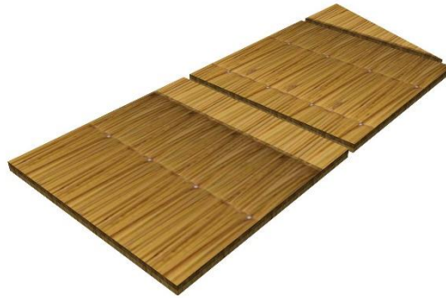
FIGURA 122. K'esana como aislante termo-acústico:
