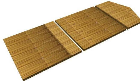
FIGURA 112. K'esana como aislante termo-acústico:
