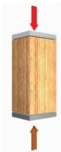
FIGURA 38. Esquema de compresión paralela a la fibra:
