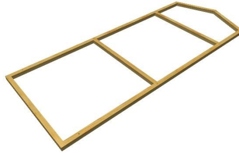
FIGURA 110. Armado de la estructura de panel: FUENTE: Elaborado por el equipo de trabajo
