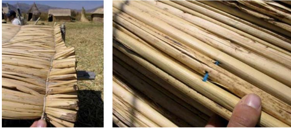
FIGURA 27. Forma de trenzado de la totora para la construcción:
