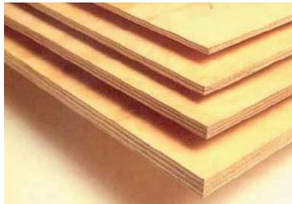
FIGURA 58. Tableros de triplay lupuna según espesores:
