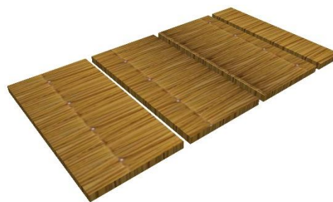
FIGURA 134. K'esana como aislante termo-acústico: FUENTE: Elaborado por el equipo de trabajo
