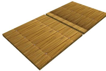
FIGURA 81. K'esana como aislante termo-acústico:
