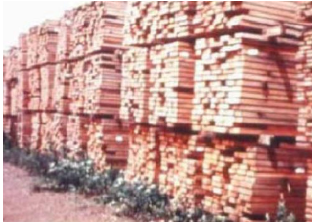
FIGURA 51. El adecuado almacenamiento del secado de la madera:
