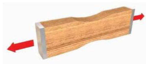
FIGURA 47. Esquema de tracción paralela a las fibras:
