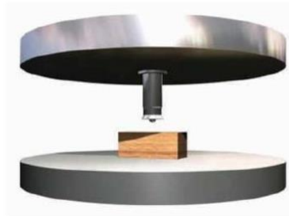
FIGURA 50. Esquema de dureza, forma normal o paralela a la fibra:
