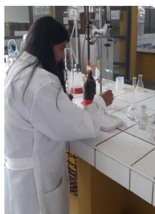
Figura 26. Determinación de acidez titulable.
