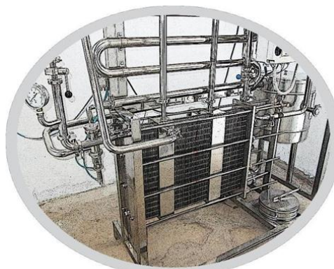
Imagen 15. Sistema a placas, es el más seguro método de pasteurización de leche.
