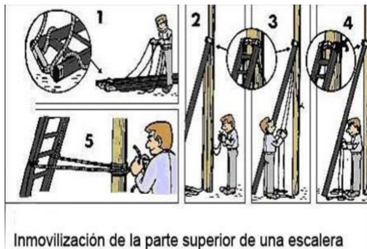
Figura N° 3. 20 Inmovilización de las escaleras
