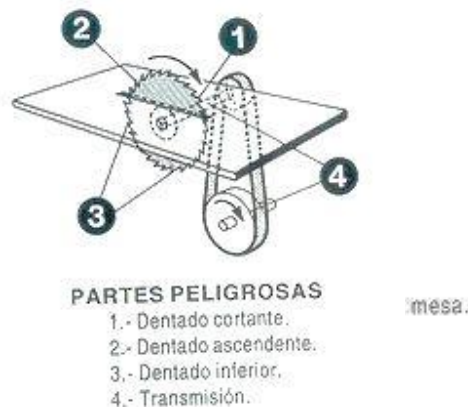
Figura N° 4. 7 Normas de seguridad para el uso se sierra circular
