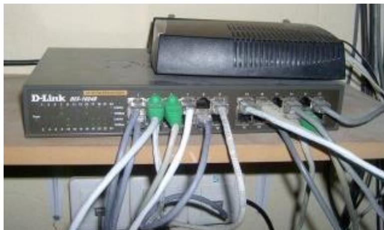
Figura 75. Switch conectado con UTP
