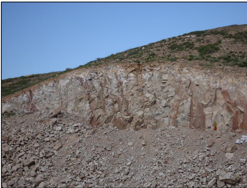
Figura 19. Perfil de banco luego de la voladura
