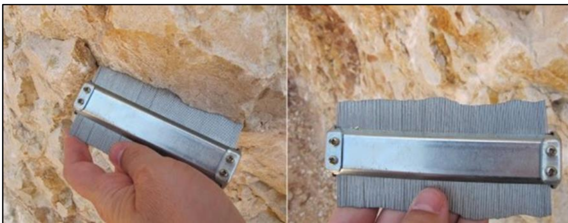
Figura 11. Peine de Barton. Toma de datos en campo.
