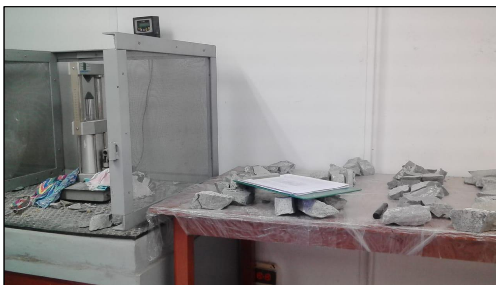
. Figura 28. Ensayo de muestra para la determinación de Resistencia a la Compresión PLT
