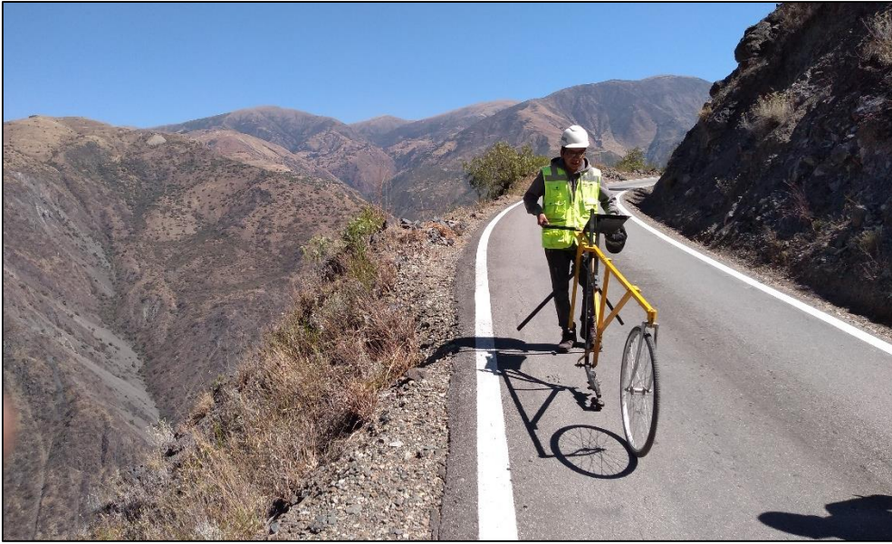
Fotografía 05. Medición y Recolección de Datos En campo con el Equipo Merlín.
