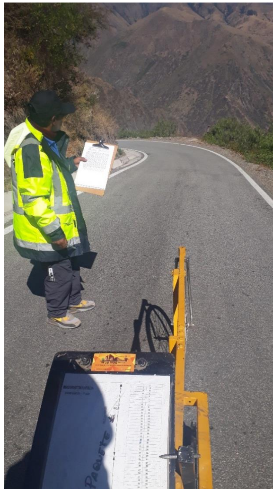
Fotografía 06. Medición y Recolección de Datos En campo con el Equipo Merlín.
