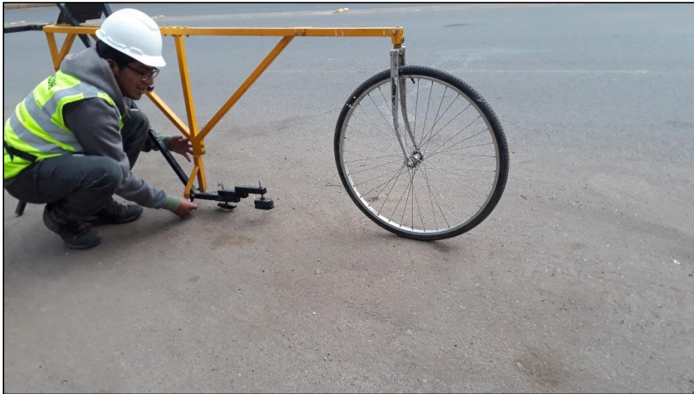
Fotografía 01. Verificación de Calibración del Equipo Merlín, Pastilla debajo del Patín Móvil.
