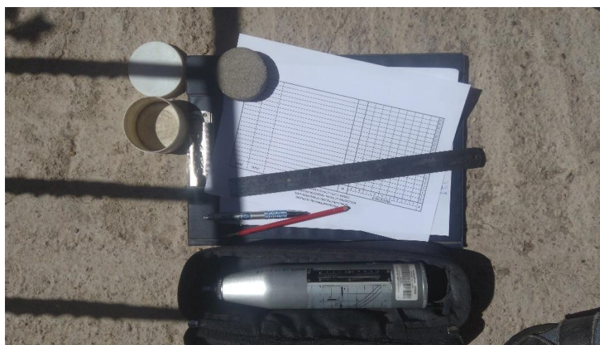
Fotografía 123: Se aprecia los equipos y herramientas utilizados como son el esclerómetro, la piedra abrasiva, ficha de recolección de datos, regla, lápiz y equipo fotográfico.
