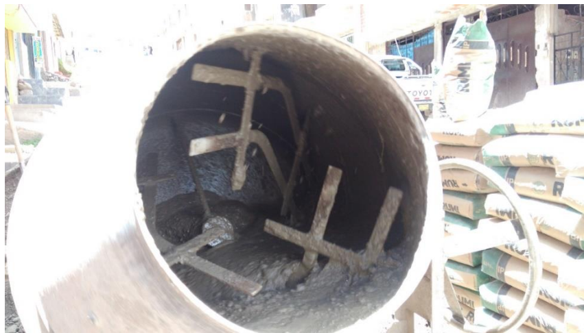
Fotografía 53: Se muestra el mezclado de los materiales que realiza la maquinaria utilizada.
