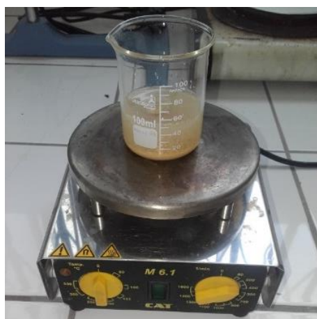
Figura 17. Adsorción de Mn del agua residual con huesos de Trucha.
