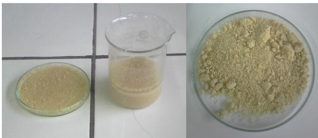
Figura 15. Activación y secado del bioadsorbente (Huesos de Trucha).
