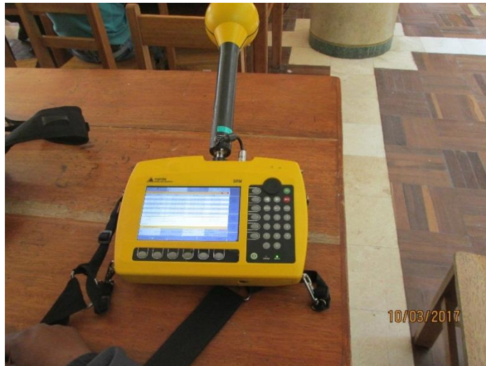
Fig. A-1 Equipo de medición de Radiación No Ionizante, marca NARDA con la antena Isotrópica
