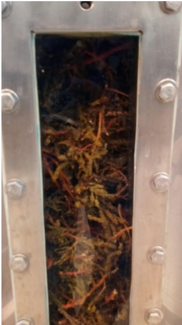
Figura E. 7: Cámara de extracción con la materia ya cargada.
