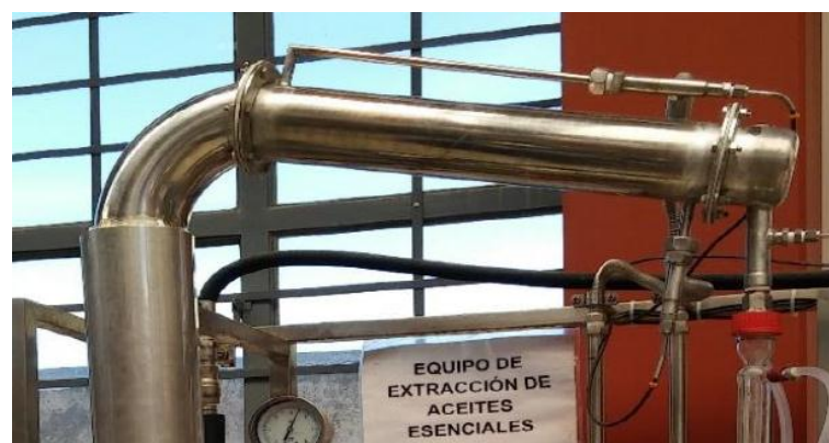
Figura 5: Condensador del equipo de extracción por arrastre de vapor.
