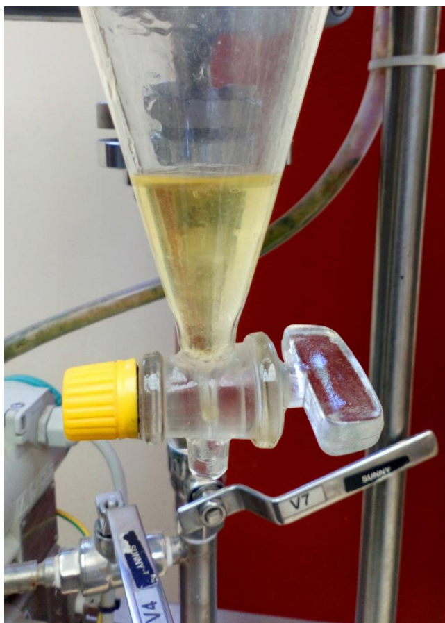
Figura E. 9: Decantación del aceite esencial de paico ( Chenopodium Ambrosioides ).
