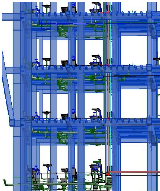
Figura 19: Visualización de instalaciones sanitarias del Proyecto 02
