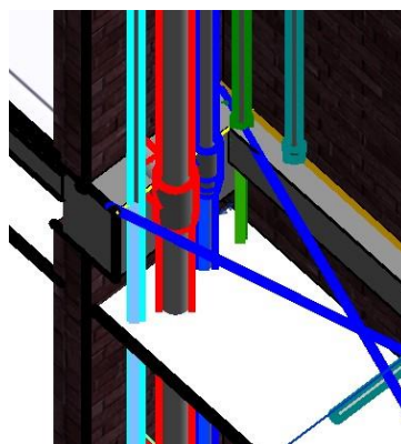
Figura 26: Incompatibilidad entre la viga y las montantes
