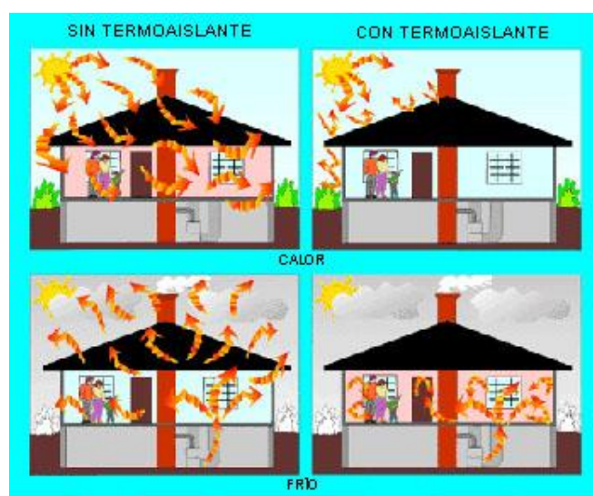
Figura 6: Comportamiento del calor y el frío, en una vivienda con y sin aislante.
