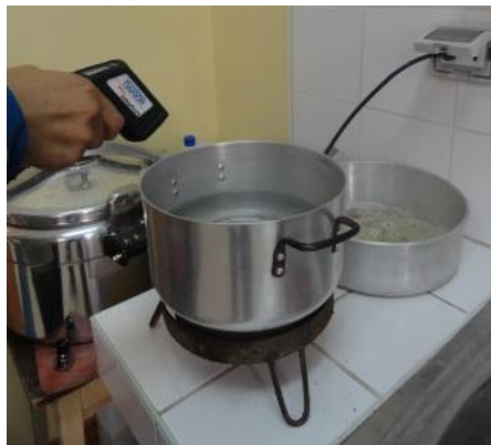
Figura 57: Medición de la Temperatura de ebullición del agua mediante el Pirómetro.
