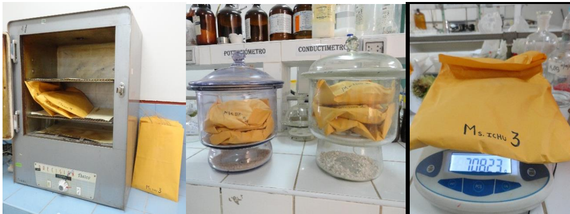
Figura 46: Ensayo de contenido de humedad realizado en laboratorio, utilizando estufa de secado, el disecador de campana y balanza de precisión.
