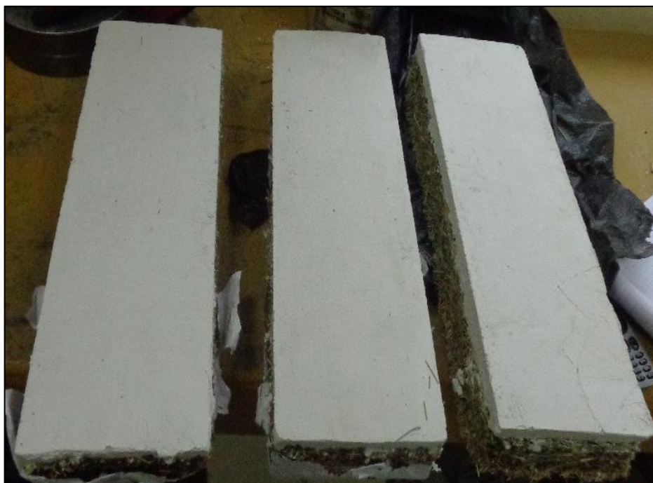
Figura 66: Testigos ensayados de Stipa Ichu con recubrimiento de Yeso.
