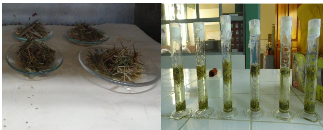
Figura 47: Muestras del Ensayo de densidad realizado en laboratorio.
