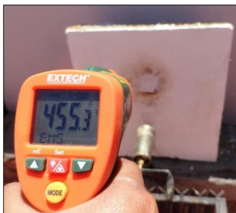
Figura 64: Toma de datos con el uso del Pirómetro.
