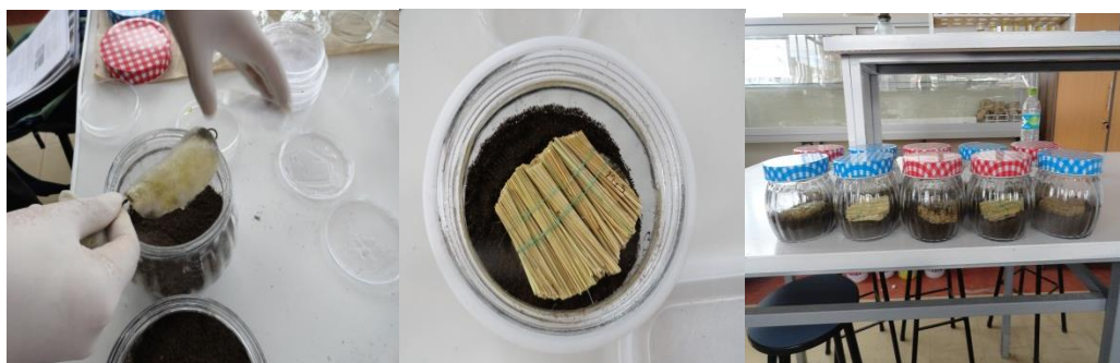
Figura 52: Procedimiento de montaje de Probetas con muestras de Stipa Ichu.
