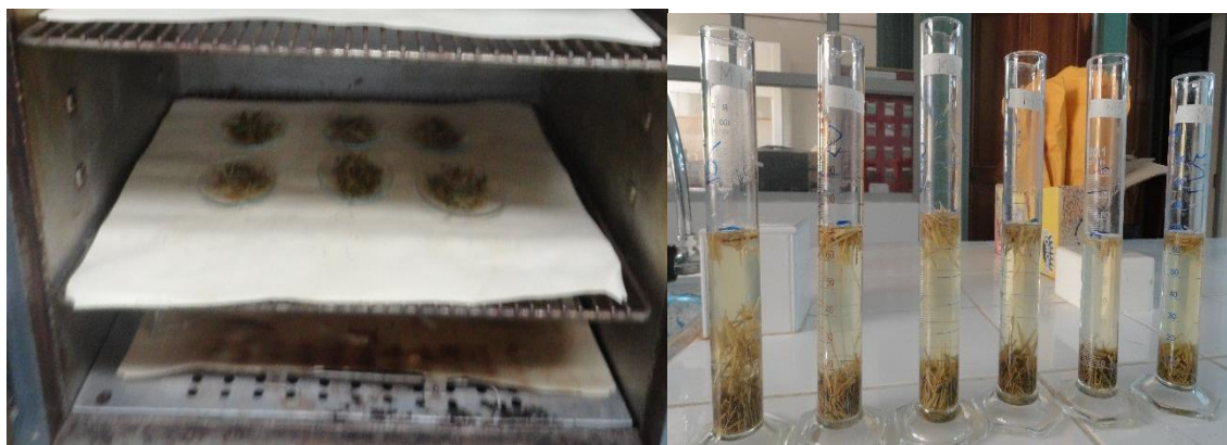
Figura 48: Muestras del ensayo de porosidad realizado en laboratorio.
