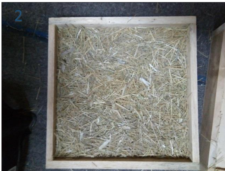
Figura 43: Colocado del Stipa Ichu picado en capas agregando cola de carpintero.
