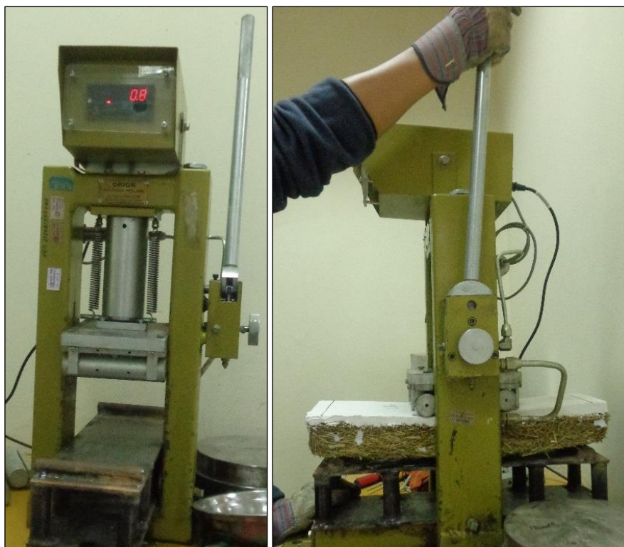
Figura 67: Carga a velocidad constante con el equipo de Resistencia a la flexión ORION.
