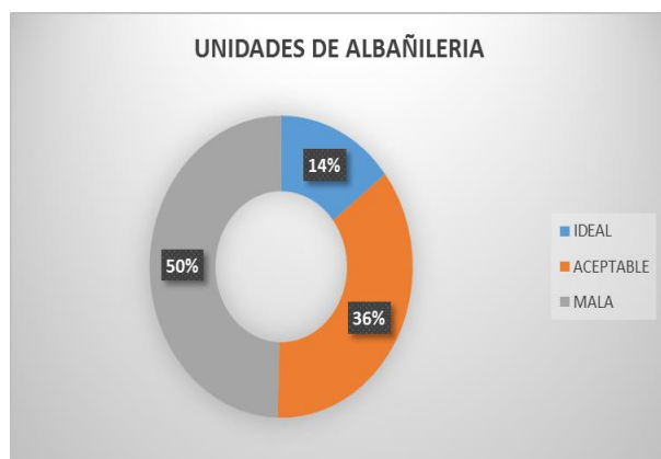
Figura N° 63: Resultado de la calidad de ladrillos utilizados en viviendas.
