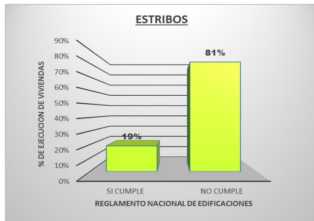
Figura N° 98: Resultado de los estribos utilizados.
