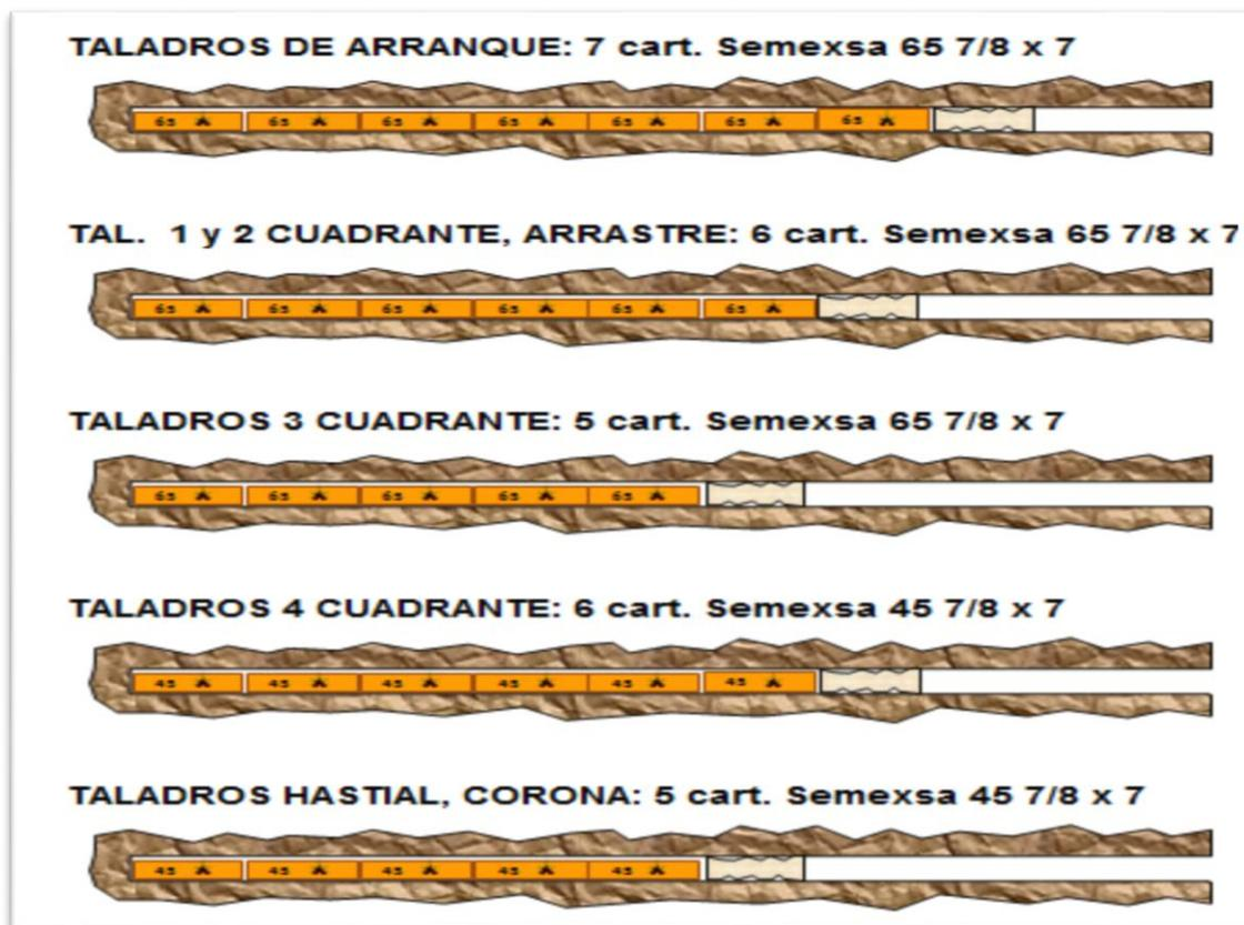
Figura 4.4 Diseño de carguío de taladros (5 pies)
