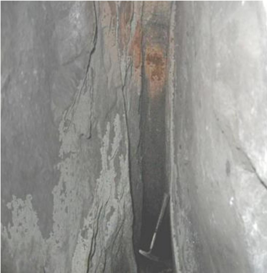
Figura 4.1 Buzamiento pronunciado de Tajeo de explotación Carlota.
