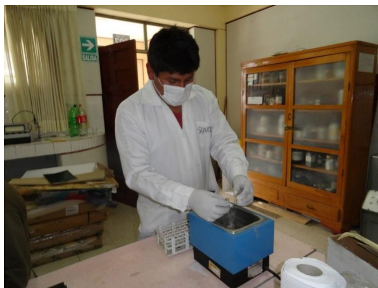
Foto 12: Baño maría de los tubos de ensayo antes de la lectura
