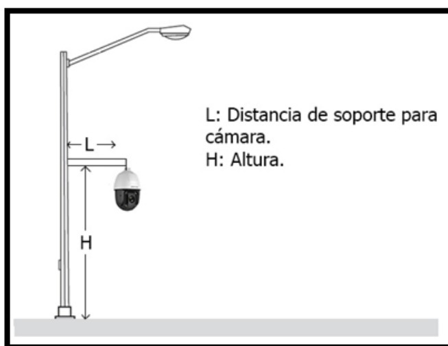
Figura 3. 33: Imagen referencial de la instalación de las cámaras PTZ.
