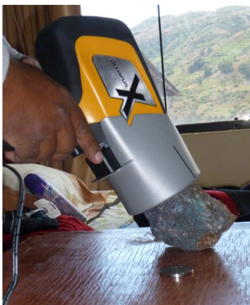
Figura 18. Calibración de equipo XRFp con moneda de Titanio y lectura de muestra de mano.
