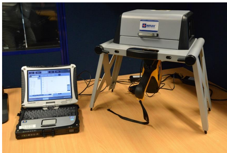
Figura 14. Equipo XRFp y accesorios utilizados en la investigación.
