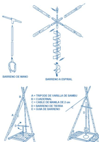
Figura N° 3.10. Equipo de perforación de pozo.
