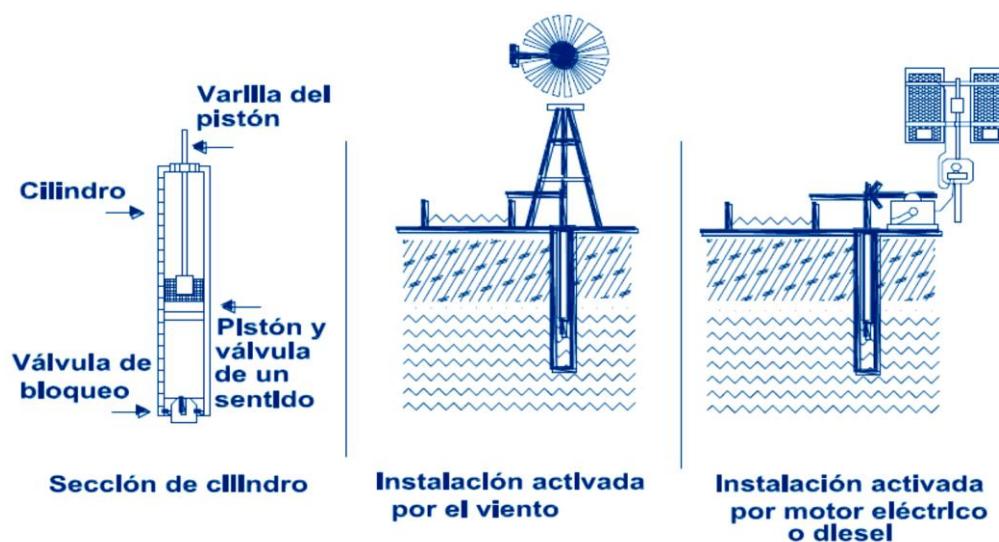
Figura N° 2.18. Esquema de una bomba volumétrica de cilindro.
