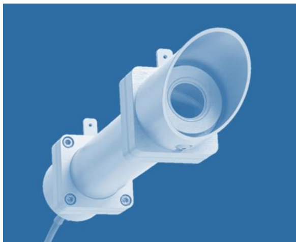
Figura N° 2.13. Representación esquemática de un pirheliómetro. Fuente. JUTGLAR, Lluís. Energía solar.
