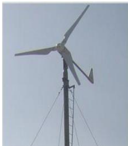
Figura N° 2.24. Aerogenerador de eje horizontal. Fuente: MORENO FIGUEREDO, Conrado. Tecnología de los pequeños aerogeneradores.
