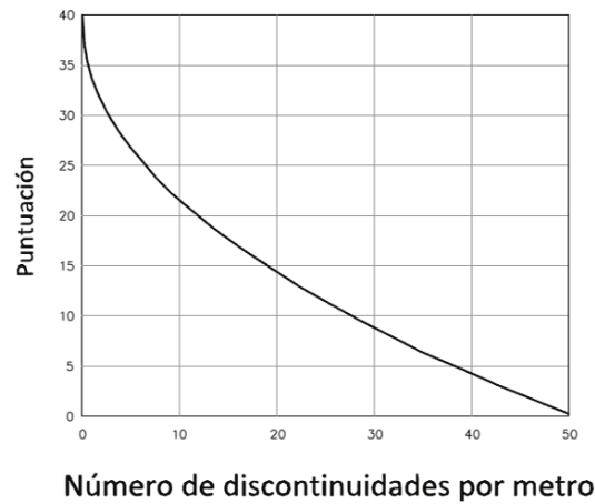
Figura 17. Gráfico para la valoración del número de discontinuidades por metro.
