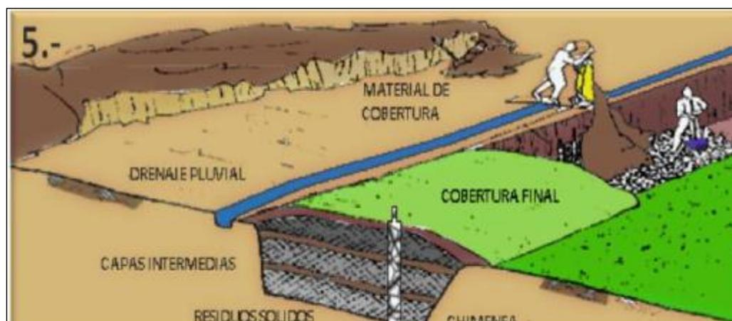
**Figura 2. Método de trinchera para relleno manual.**
