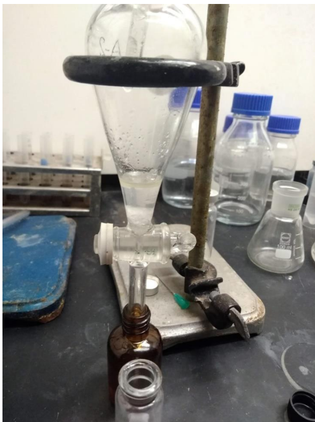
Figura B. 11. Decantación del aceite esencial (separación del agua y el aceite).
