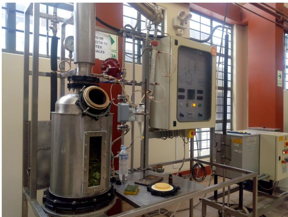
Figura B. 1. Equipo de extracción de aceite esencial por arrastre de vapor
