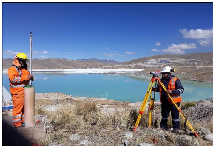
Figura 20: Ingeniero Topógrafo realizando la nivelación diferencial
