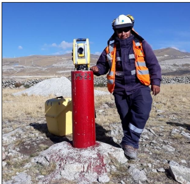
Figura 14: Lectura de ángulos con Estación Total Trimble S6
