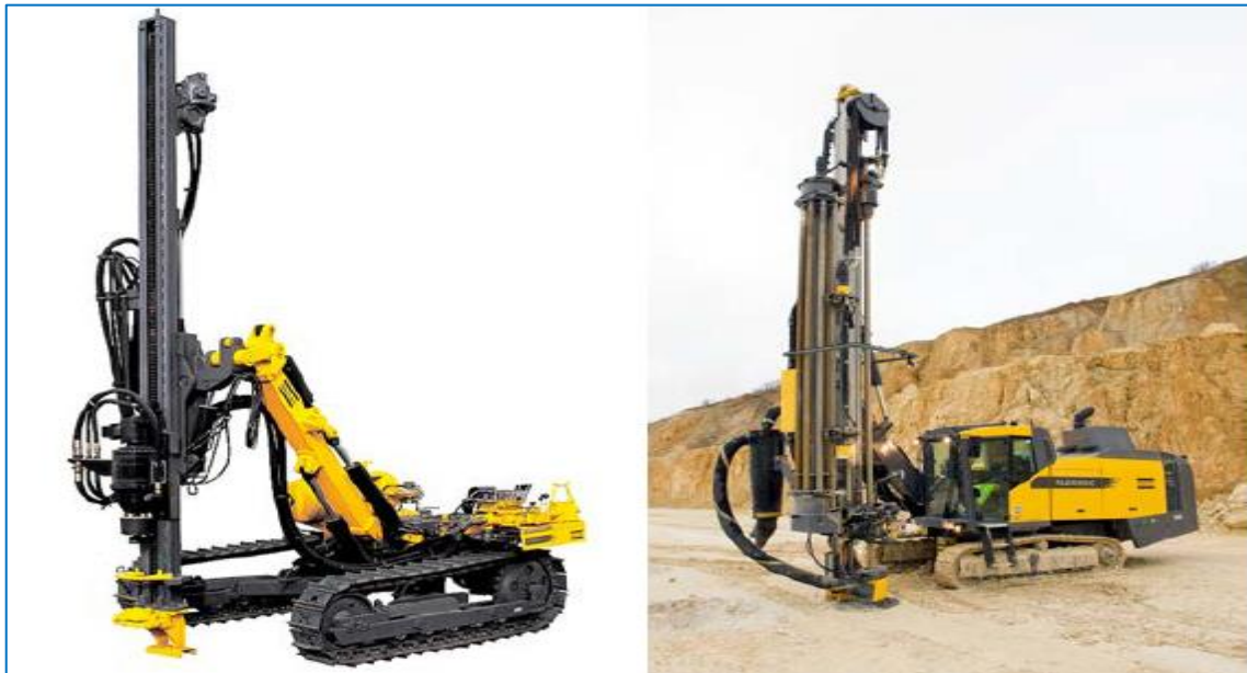
Figura 2.2: Perforadora con martillo en cabeza y con martillo en fondo.
