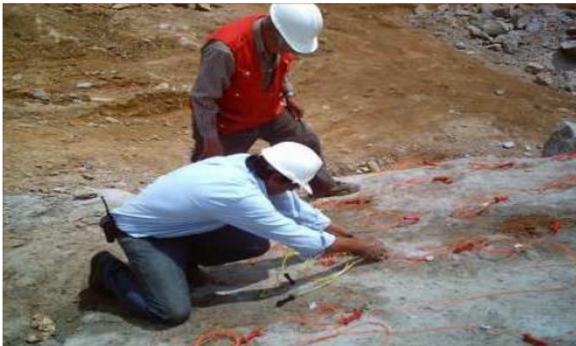
Figura 2.3: Secuencia de amarre de taladros en una cantera.
