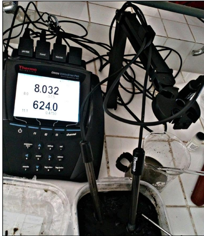
A.11. Multiparámetro digital ORION VERSTAR PRO
