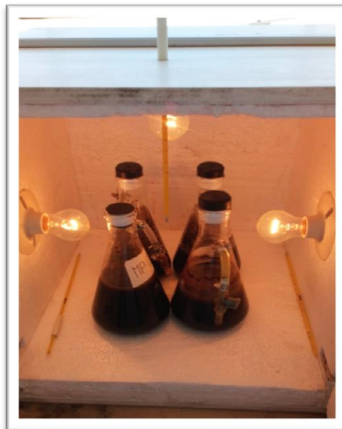
Figura 7: Incubadora para los ensayos de biodegradabilidad
