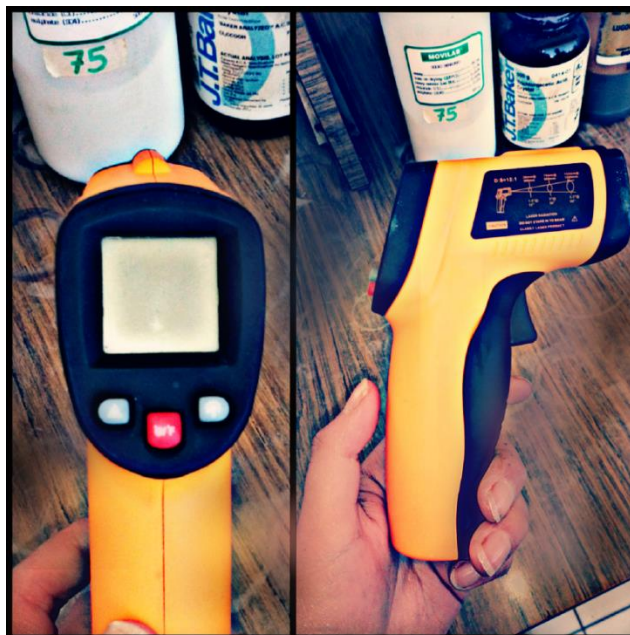
A.7. Termómetro infrarrojo GM550
