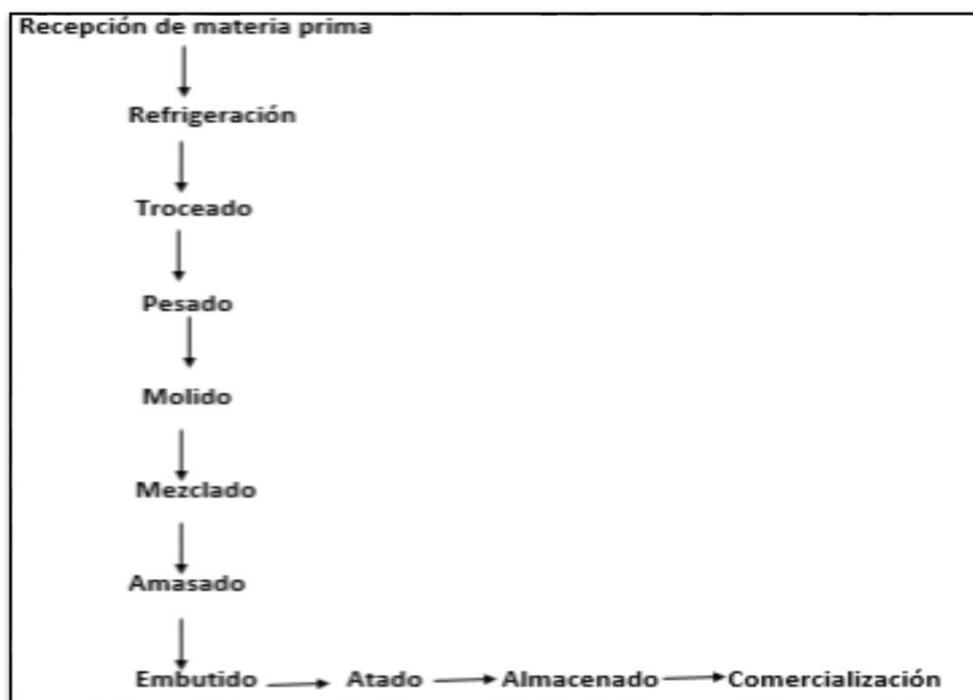
Figura 1. Flujograma del proceso de elaboración de chorizo.
