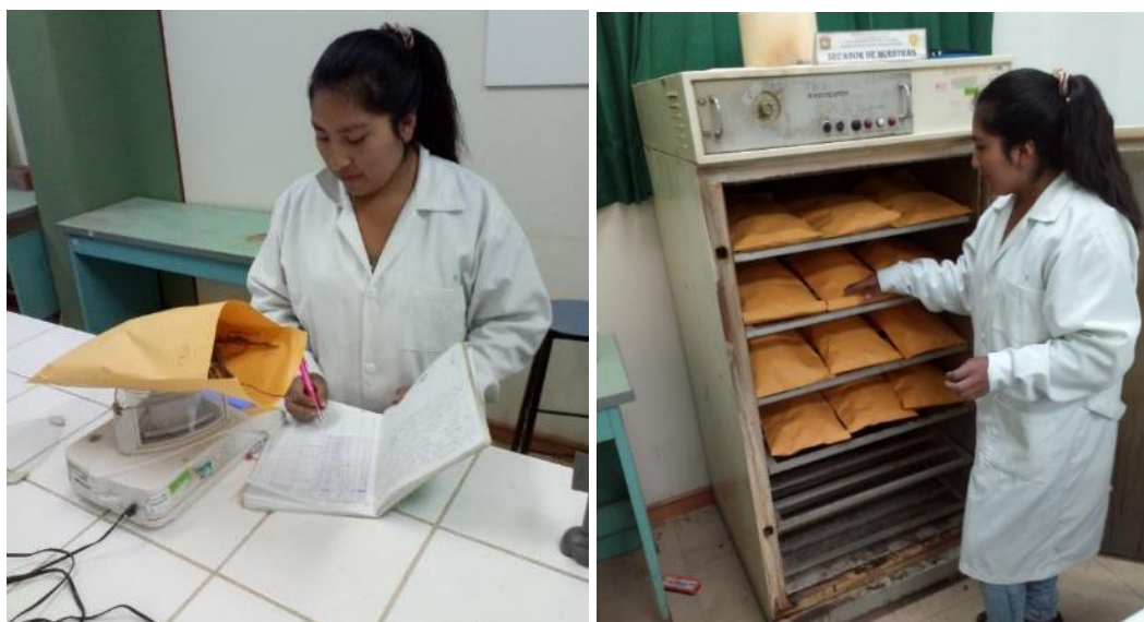
Figura 36. Pesado de muestras por componente y muestras en estufa para análisis de humedad y MS. En el Laboratorio de Pastos y Forrajes UNA PUNO – 2018.
