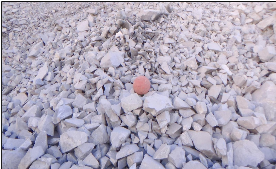
Figura 4.26: Fragmentación del proyecto 4275 – 137 en la parte del centro del banco.
