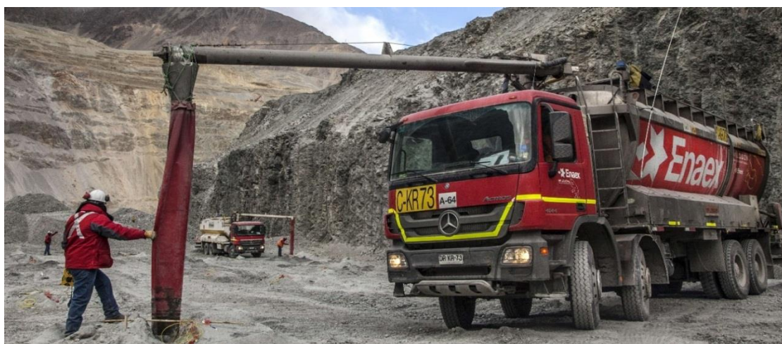
Figura 4.1: Carguío de taladros con camiones mezcladores.
