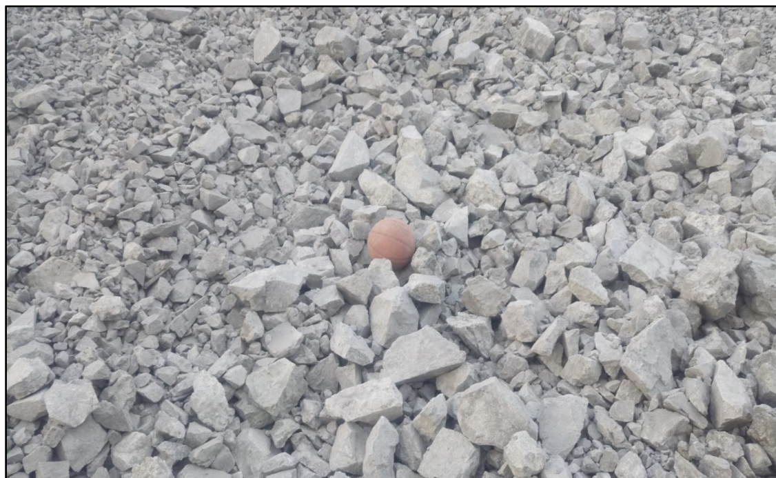
Figura 4.24: Fragmentación del proyecto 4275 – 136 en la parte del talud de banco.
