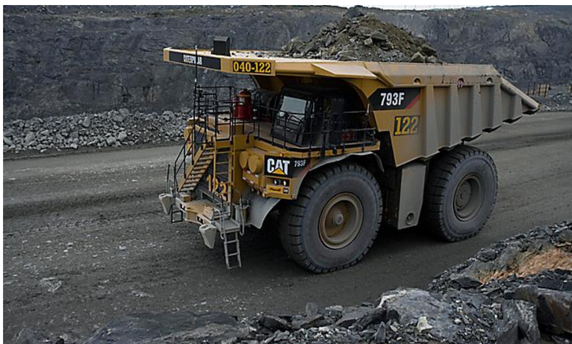
Figura 4.3: Transporte de material con el camión CAT 793F.
