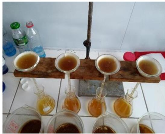
**Foto 13. Filtrado del coagulado-floculado listo para el análisis correspondiente**
