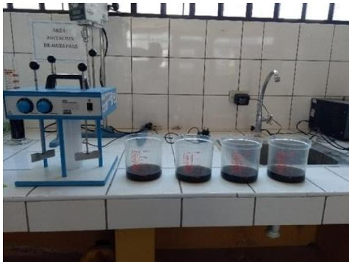
**Figura 9. Instalación experimental para el ensayo de coagulación**
