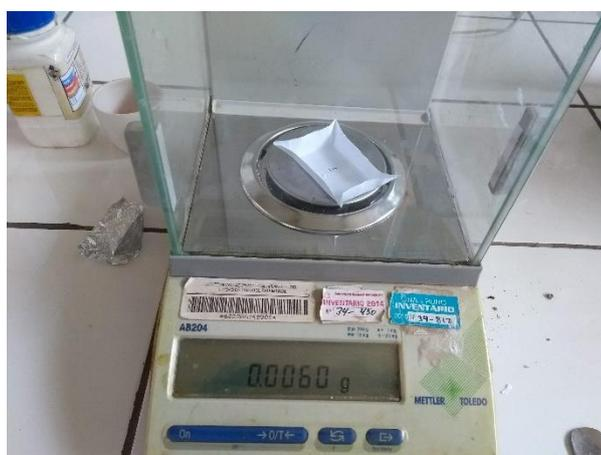
**Foto 5. Peso del sulfato de aluminio**
