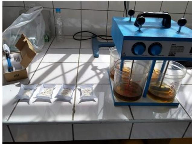
**Foto 6. Peso del floculante para incorporar al coagulo**
