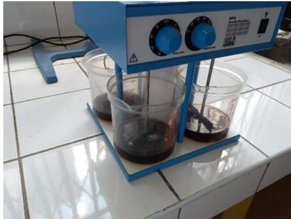
**Foto 9. Lixiviado en el Jar Test**
