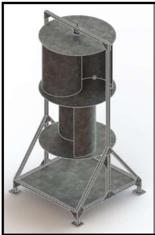
Figura N° 28 Ensamblaje de los componentes del aerogenerador
