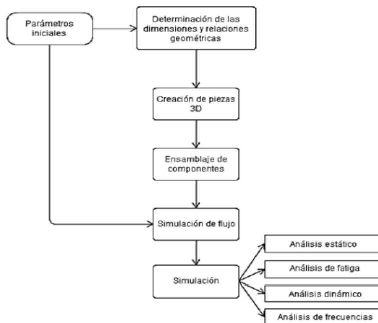
Figura N° 24 Proceso para la simulación del sistema eólico
