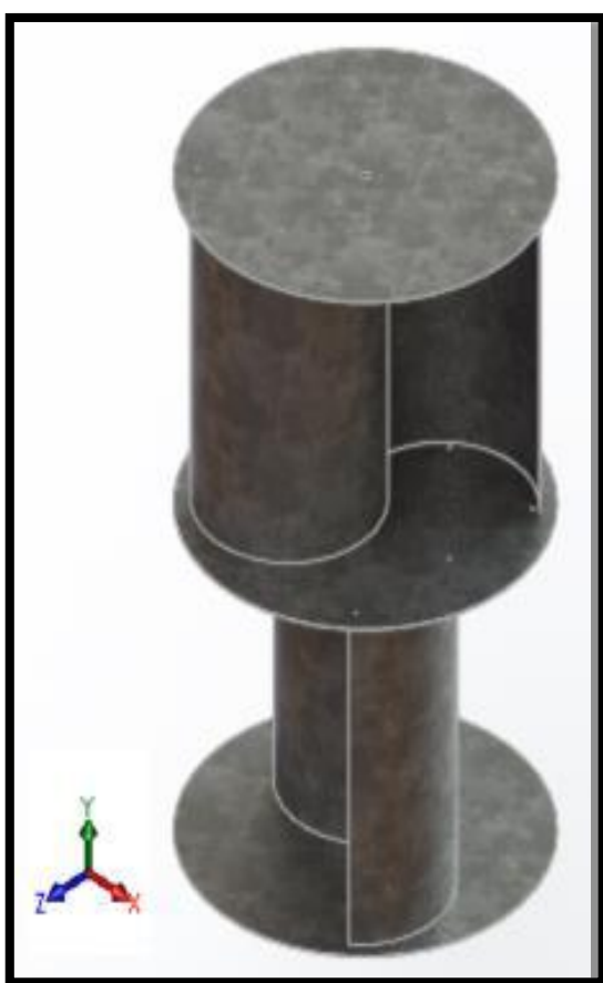
Figura N° 25 Modelo tridimensional del rotor
