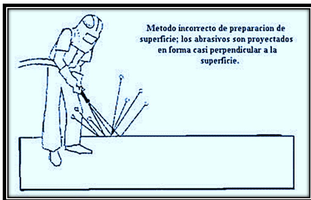
Figura 16. Método incorrecto inclinación y distancia inadecuada de la boquilla.
