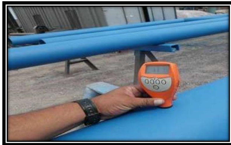
Figura 25. Instrumentos de Inspección de Película de Pintura Elcometer.
