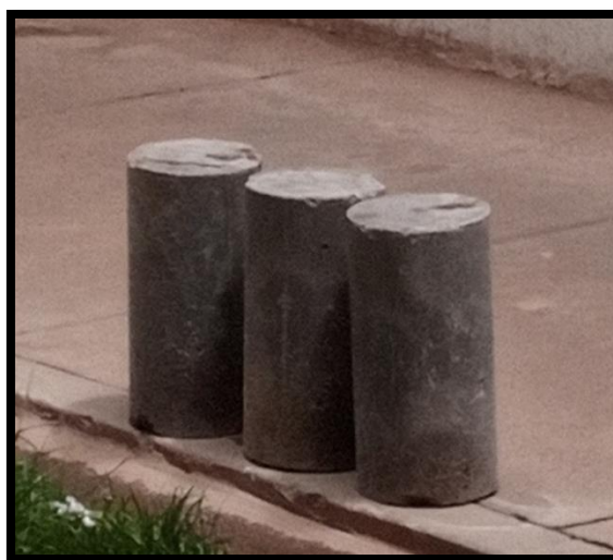
Figura 21: Testigos de concreto a ser rotos Fuente: Elaboración por el equipo de trabajo
