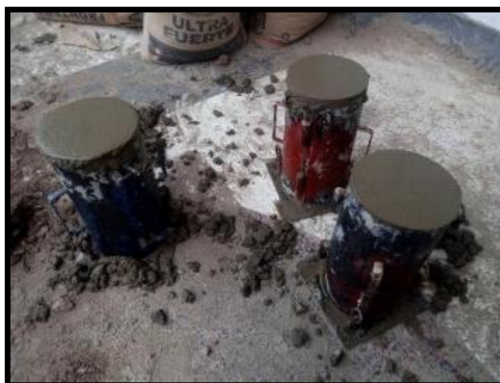
Figura 20: Testigos de concreto
