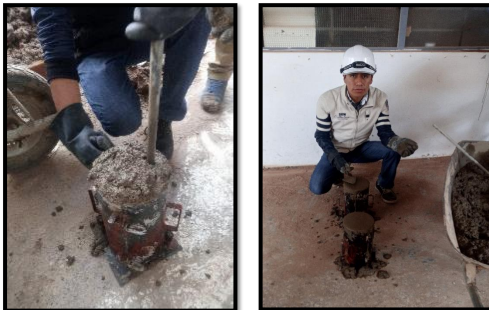
Figura 19: Elaboración de testigos de concreto
