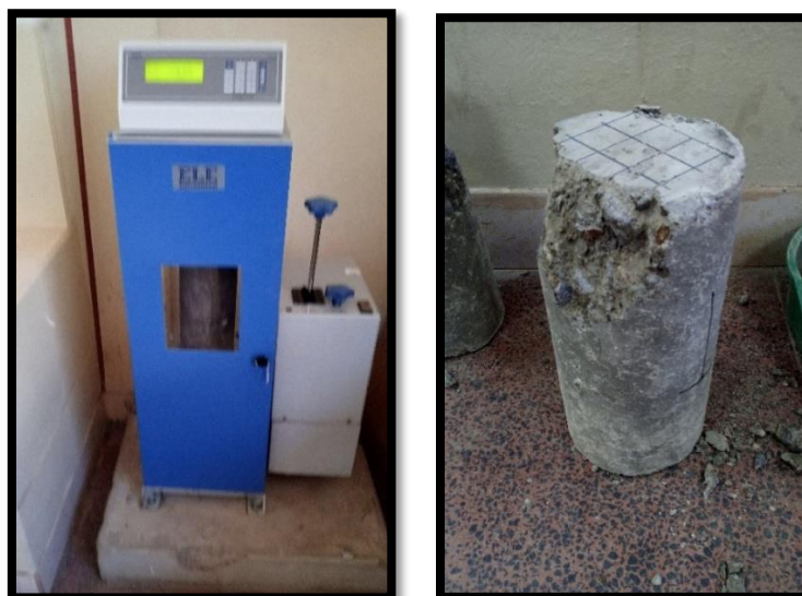
Figura 22: Rotura de testigos de concreto con fines de contrastación Fuente: Elaboración por el equipo de trabajo
