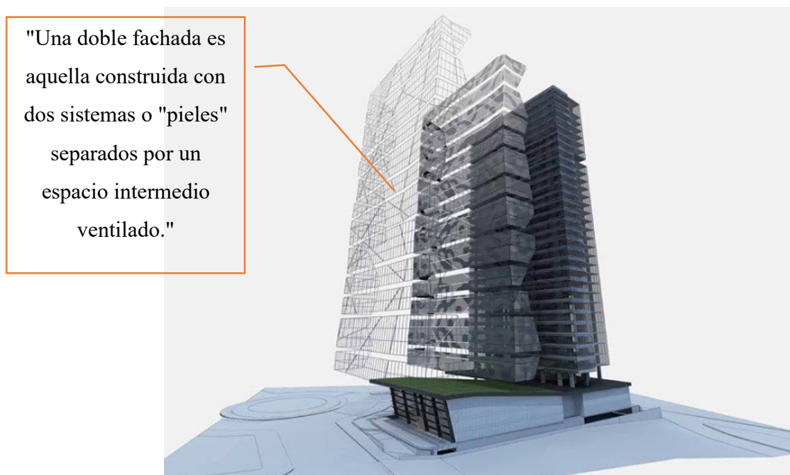
Figura 93: Ejemplo del funcionamiento de una doble piel
