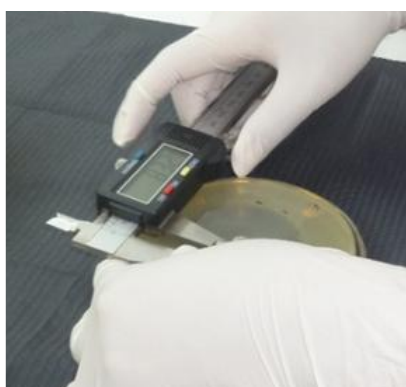
Figura 33. Medición de halos de inhibición utilizando vernier.
