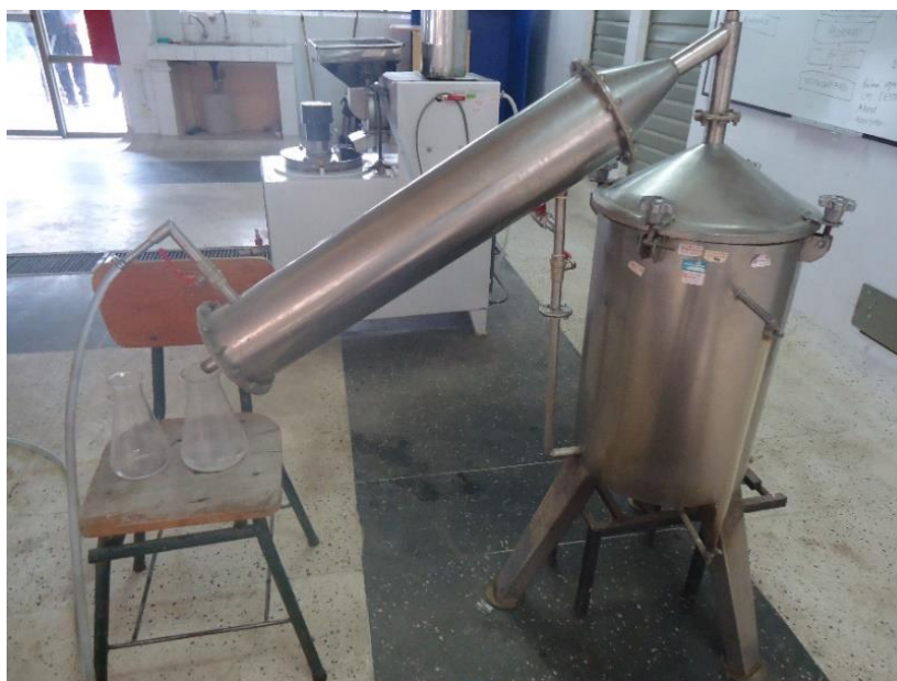
Figura 23. Obtención del aceite esencial de hojas de Minthostachys mollis (muña) por el método de destilación de arrastre por vapor.
