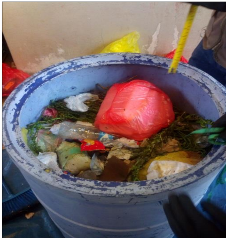
Figura 18. Determinación de la densidad de residuos sólidos
