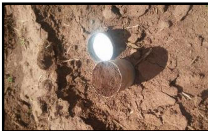
**Figura 7.** Muestreo del suelo para hallar la humedad gravimétrica del suelo
