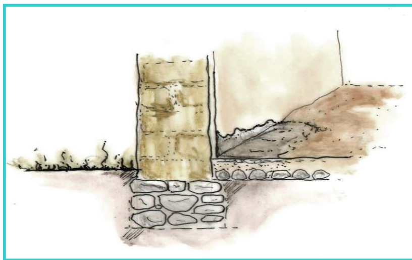
Figura 33: Se Observan Manchas Que Oscurecen el Suelo y Dañan el Acabado del Piso y Pueden Llegar a Afectar la Pared
