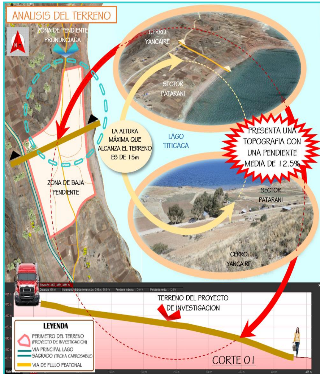
Figura 175: Topografía del Terreno del Proyecto de Investigación Fuente: Elaboración Propia
