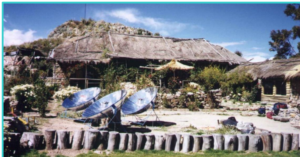
Figura 64: Vista de las cocinas solares Albergue Rural - Isla Suasi Fuente: http://fc.uni.edu.pe/mhorn/Albergue%20Suasi%20(PAE).pdf
