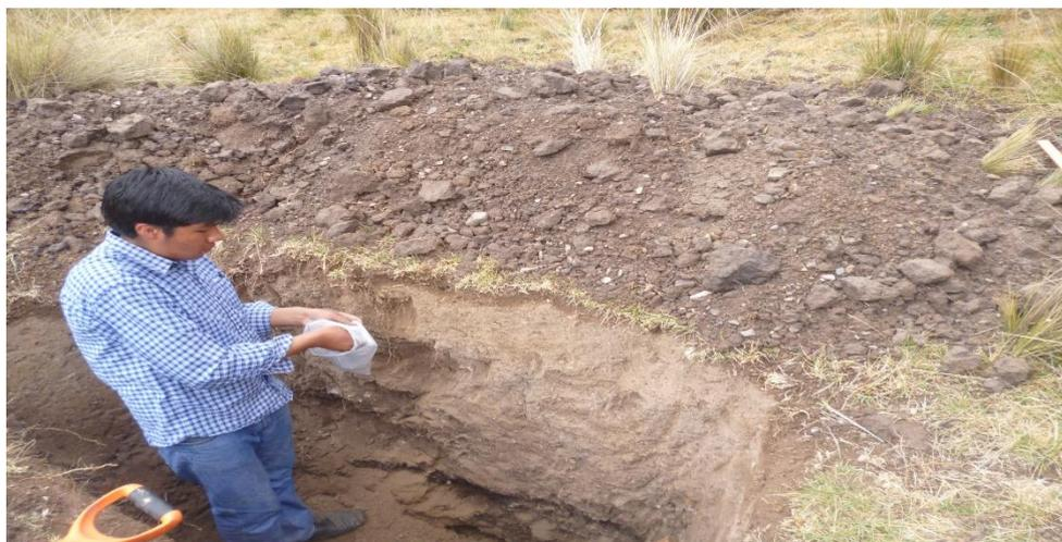
**FIGURA 25.** Apertura de una calicata y muestreo de suelo del área total para el análisis inicial de caracterización en laboratorio de suelos y aguas. 16/10/17
