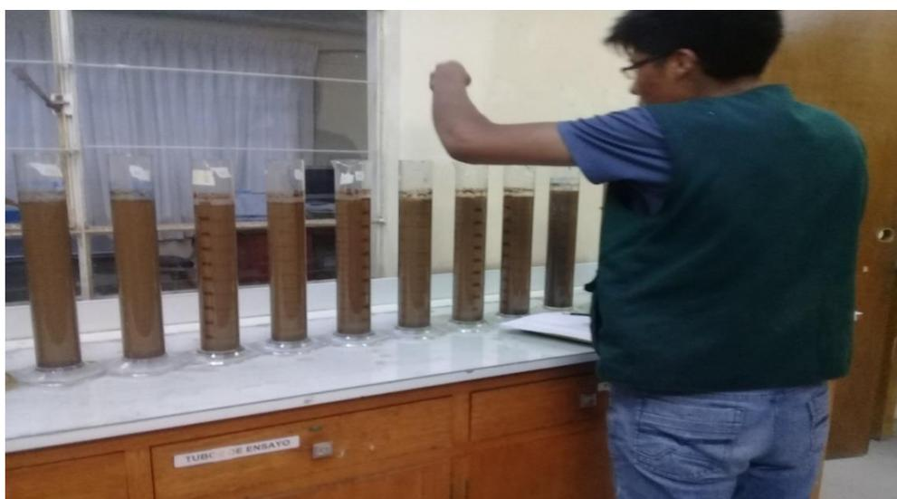
**FIGURA 47.** Determinación del porcentaje de la textura del suelo (arena, arcilla y limo) después del encalado. 01/08/18
