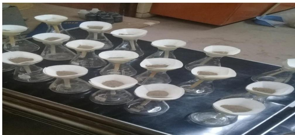
**FIGURA 45.** Preparación de muestras para el análisis de capacidad de intercambio catiónico, calcio, magnesio, potasio cambiante, sodio cambiante, hierro y aluminio del suelo después del encalado. 19/07/18
