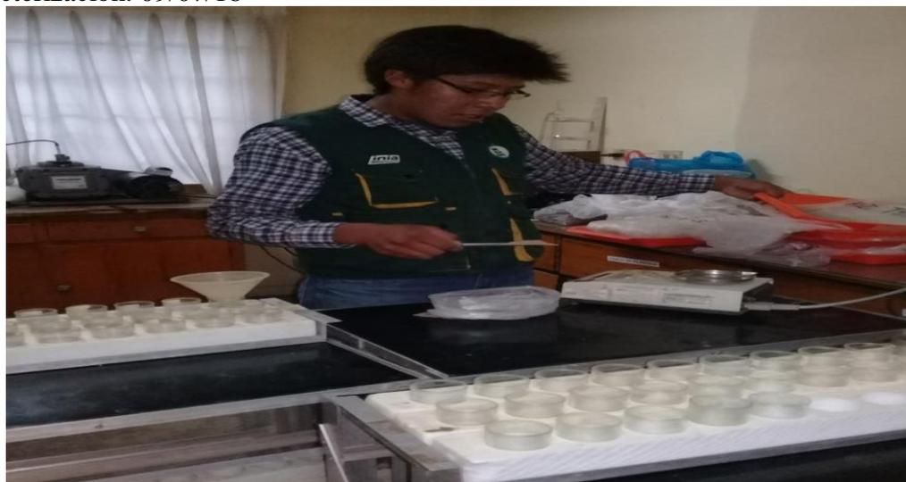
**FIGURA 41.** Pesado de muestras para el análisis de caracterización del suelo después del encalado. 18/07/18
