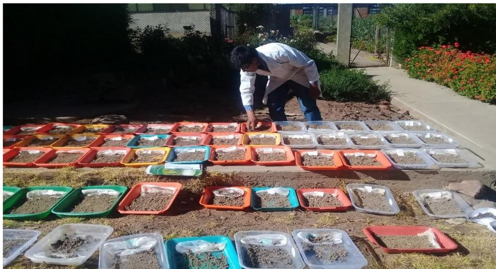
**FIGURA 40.** Secado de muestras de suelo después del encalado para el análisis de caracterización. 09/07/18
