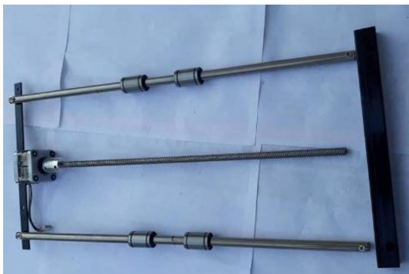
Figura 2.84. Armado de varillas del eje Z
