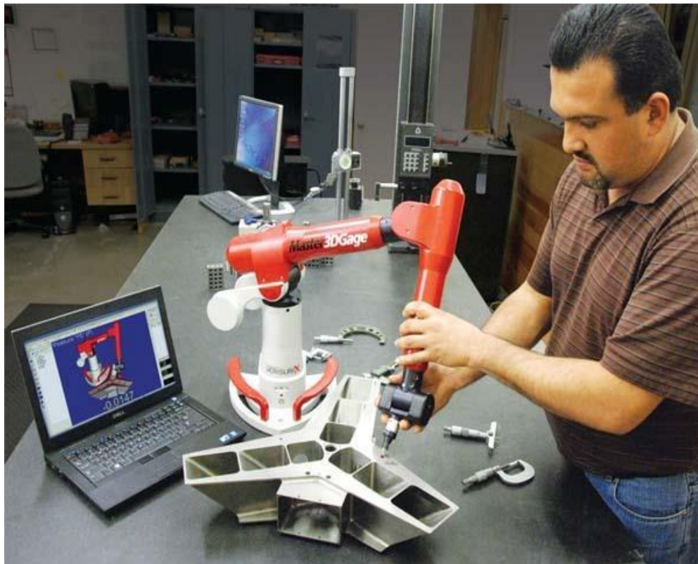
Figura 2.30. Escaneo por medio de punta exploratoria en brazo robot
