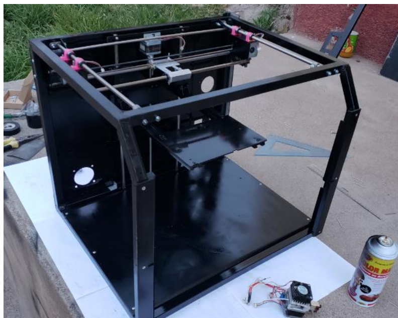
Figura 2.86. Ejes XYZ en la Estructura
