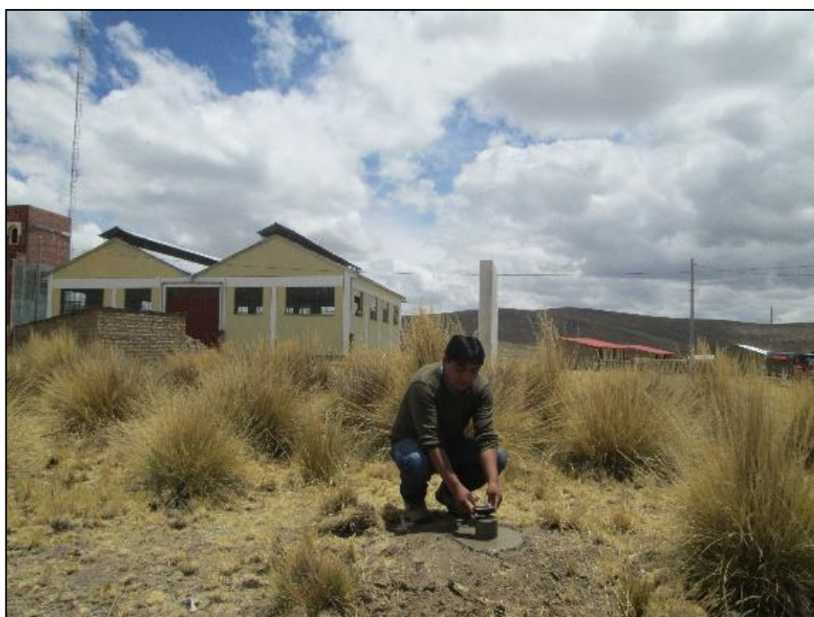
IMAGEN 2. Se muestra la monumentación de para control geodésico de orden "C" en sector Tulani
