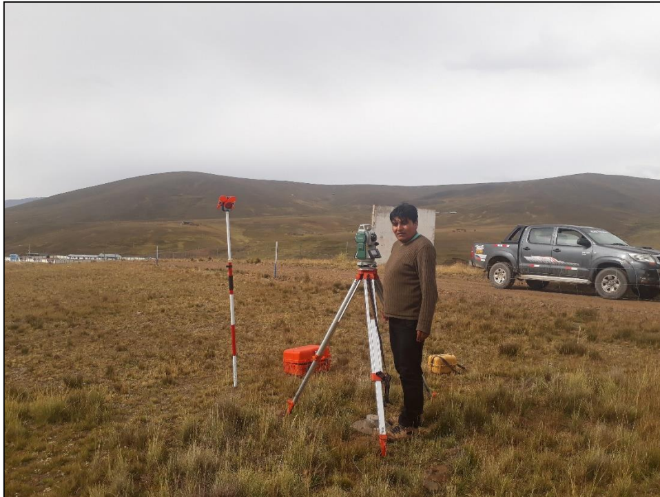
IMAGEN 7. Se muestra el levantamiento topográfico por método radiación en sector Altura desde en el punto de control geodésico.
