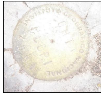
Figura 18 Punto de Control Geodésico
