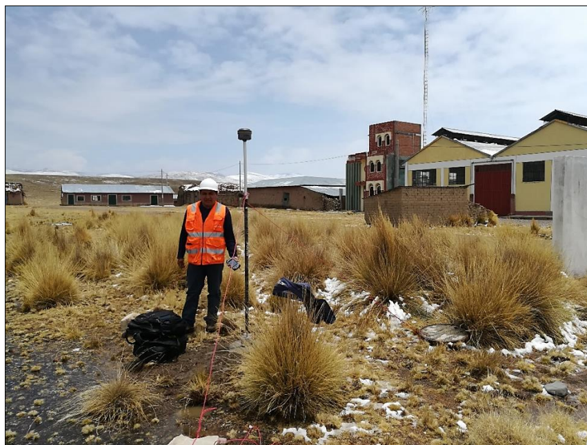
Figura 20 Colocación de GPS diferencial en sector TULANI
