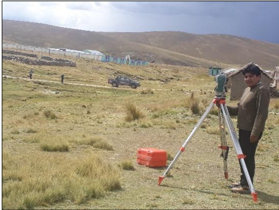
IMAGEN 5. Se muestra el levantamiento topográfico con estación total en sector Tulani.
