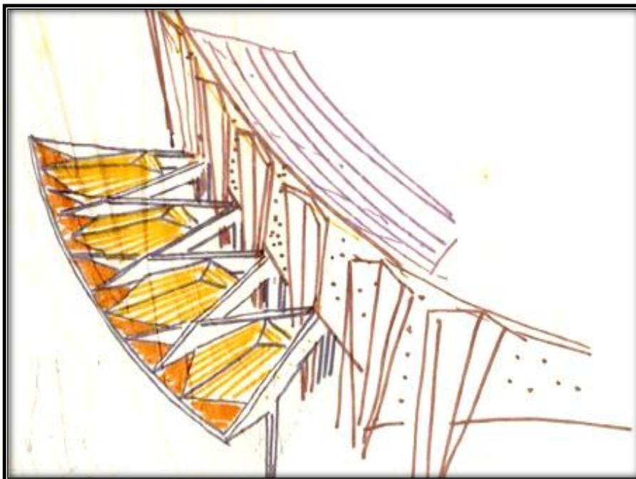
**Figura 15:** Estructura de soporte de la cobertura del Coliseo el Gran Chimú
